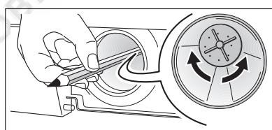
6. Вставьте крышку насоса. Перемычки на крышке введите в расположенные по бокам направляющие пазы и плотно заверните крышку в направлении часовой стрелки.
